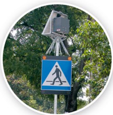
Znak D-6 z aktywnym panelem sprzężonym z czujnikiem ruchu zasilany baterią słoneczną
